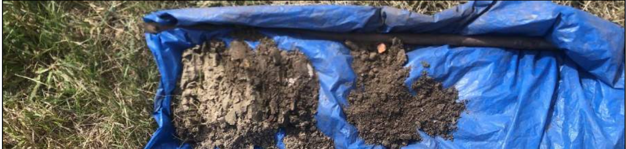
Boring 3: 0-60 cm -Mv, meermaals gestaakt op puin.
