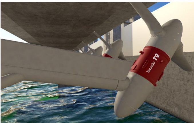
Getijdecentrale in de openingen van de Oosterschelde Stormvloedkering.
