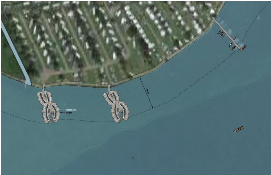
Figuur 2.3 Ontwerp van de twee steigers waarop ca. 26 geschakelde waterwoningen zijn voorzien (Bron: WTS mei 2020).
