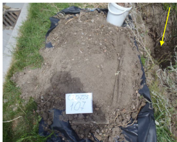
Foto 8: Inspectiegat G107 (gele pijl) met uitgegraven bodemmateriaal.
