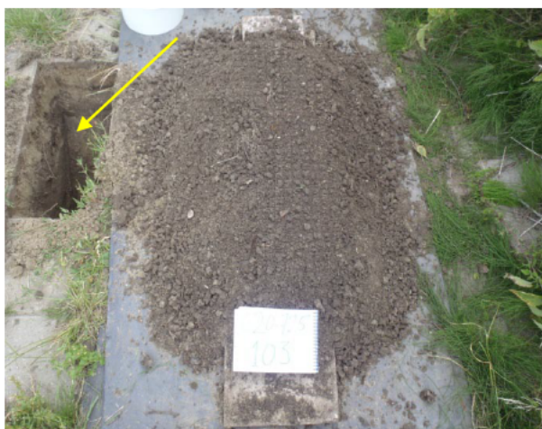
Foto 7: Inspectiegat G103 (gele pijl) met uitgegraven bodemmateriaal.
