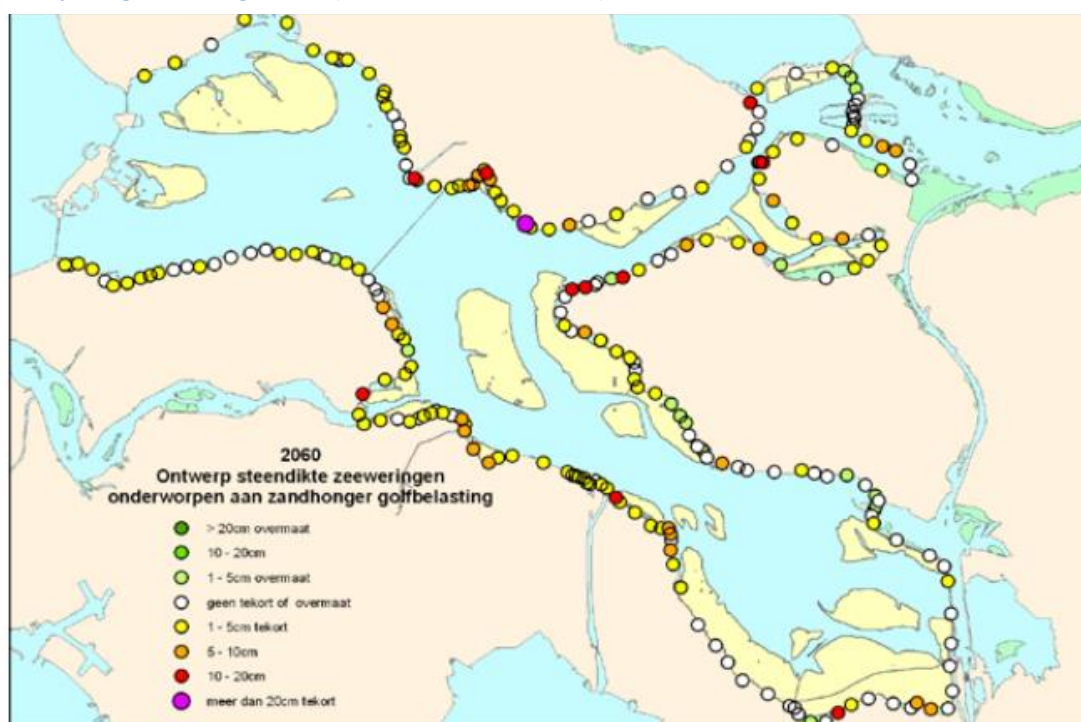
Figuur 9: Ontwerp van de steenbekleding in vergelijking met de benodigde dikte van de steenbekleding bij de voorspelde golfbelasting in 2060 (Zanten & Adriaanse, 2008).
