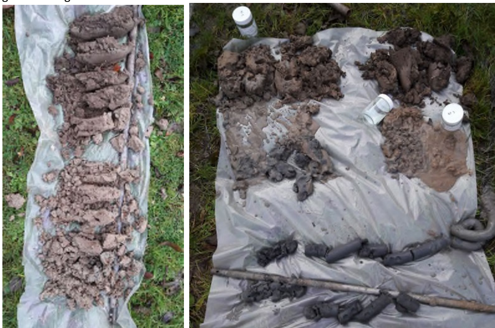
Afb. 18. Typisch beeld van een ondiepe boring (1 m-mv) en een diepe boring (3,5 m-mv).
