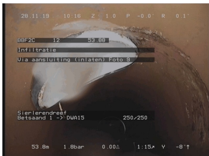
Infiltratie - Via aansluiting (inlaten)
